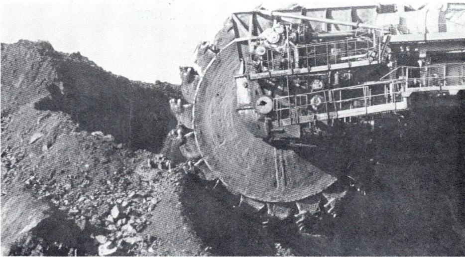
Les excavateurs géants servant à extraire les sables bitumineux de l'Athabasca pèsent 1 700 tonnes et sont équipés de roues-pelles ayant un débit de plus de 50 000 tonnes de sable bitumineux par jour.
