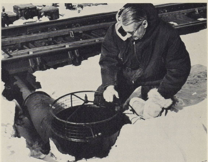
Project Engineer J. F. Lane examines air intake of switch heater at test site on Elliot Siding near Perth, Ont. ● M. J.F. Lane, ingénieur chargé de l'étude, examine l'entrée d'air du réchauffeur d'aiguillage à l'essai à Elliot Siding, près de Perth, dans l'Ontario.
