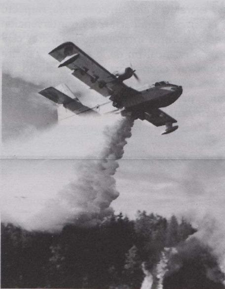
La flota de aviones contra incendios de Ontario ha añadido dos CL-215 a sus filas. Capaz de lanzar 4.500 litros de agua sobre un incendio forestal en una pasada, la ventaja principal del avión es su habilidad de recoger una carga de agua en 10 segundos conforme vuela a altura del agua de un río o lago cercano al incendio. Quebec cuenta con 15 de dichos aviones y Manitoba con tres, y también se utilizan en Francia, Italia, Grecia, Tailandia, España, Venezuela y Yugoslavia.
