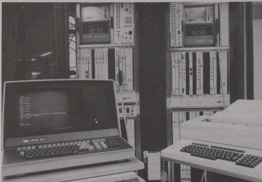
Der Welt bislang größte Erstkonfiguration eines öffentlichen Datennetzes, das von der Deutschen Bundespost im August 1980 in Betrieb genommene DATEX-P System, hat die von den kanadischen Northern Telecom Werken entwickelten SL-10 Datenvermittlungs-Anlagen zum Herzstück.
