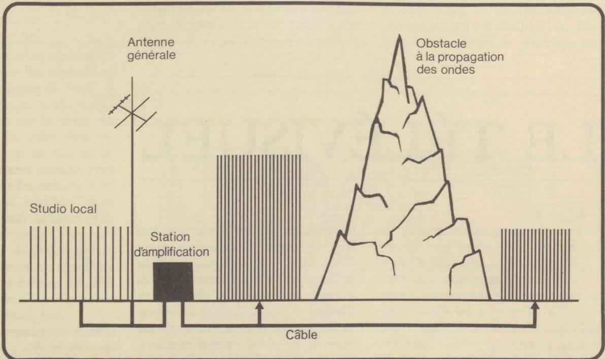
▲ Schéma de la télévision par câble : une entreprise de télédiffusion dispose d'une antenne, qui lui permet de recevoir les programmes de Radio-Canada et des stations privées, et d'un studio de production de programmes locaux ; au moyen de câbles coaxiaux, elle distribue l'ensemble des programmes à ses abonnés.
