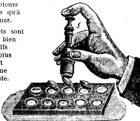
Le *Compresso-Doseur* devient Cacheteur des *Capelliformes* en remplaçant son cylindre par celui du Cacheteur.
