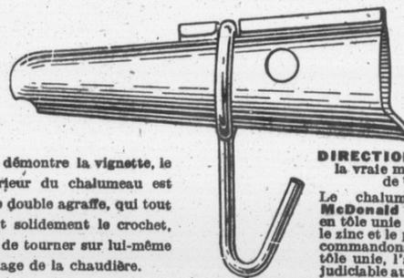
Comme le démontre la vignette, le Joint extérieur du chalumeau est muni d'une double agrafe, qui tout en retenant solidement le crochet, lui permet de tourner sur lui-même pour le vidage de la chaudière.
