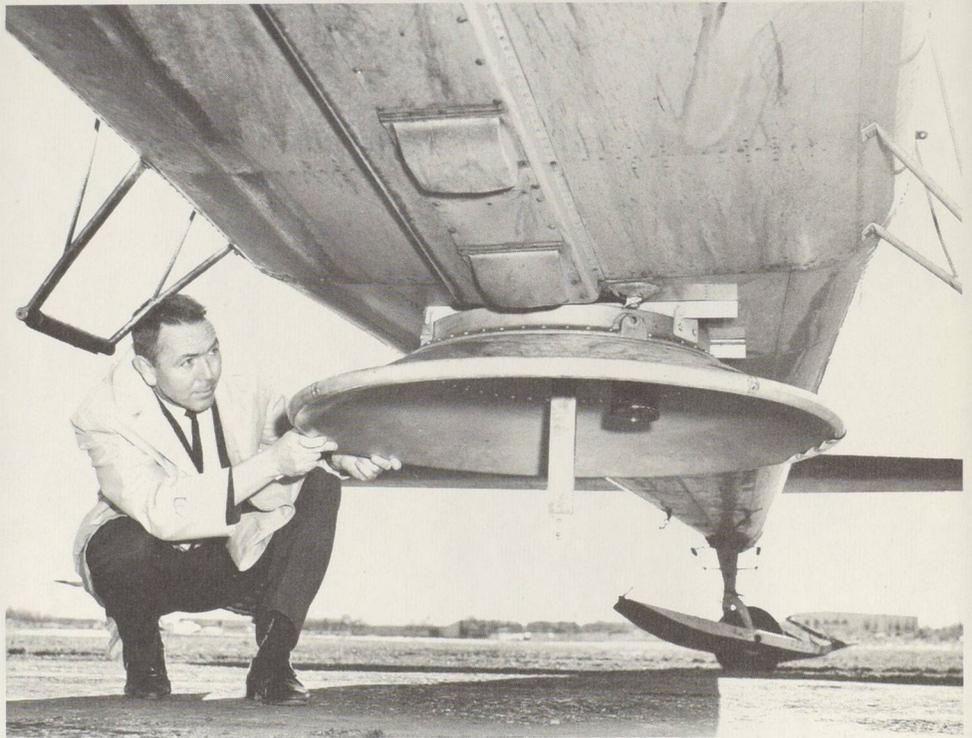
*Monsieur Ray Westby de la Division de génie électrique inspecte l'antenne du radar-altimètre qu'il a mis au point. Ce radar-altimètre émet un signal d'environ 4 200 MHz. Avec une très grande antenne on peut tout aussi bien employer des signaux de fréquence moindre, mais c'est bien du poids pour un avion léger . . .*
