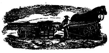
La machine à battre représentée dans la gravure plus haut est notre moulin Vibrateur. Cette machine a un silon de 28 pouces de long, les dents sont en acier garanti pour plier à froid sans se casser, tel que le norway.
