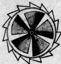
Il est mis en mouvement, non seulement par le moindre vent, mais aussi par la différence de température de l'intérieur et de l'extérieur de la bâtisse. L'hélice placée à l'intérieur de ce ventilateur non seulement établit un courant d'air continu, mais aspire toutes les poussières, la fumée, les vapeurs, l'air vicié, etc.
