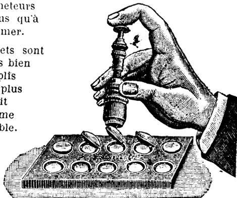
Le *Compresso-Doseur* devient Cacheteur des *Capelliformes* en remplaçant son cylindre par celui du *Cacheteur*.
