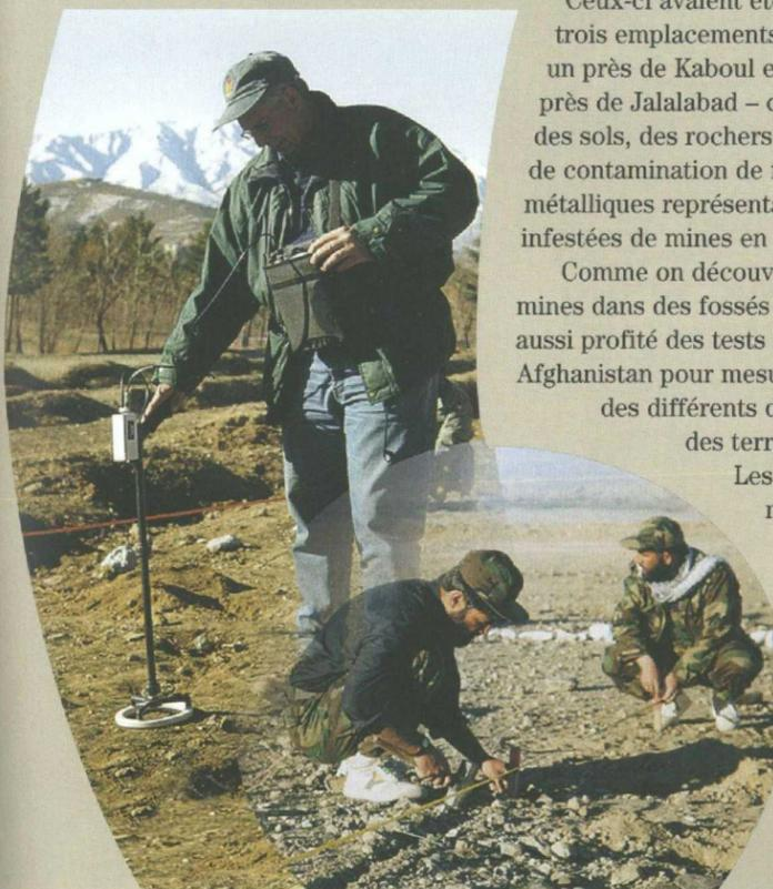
Mise à l'essai de détecteurs de métal en terrain humide dans un champ de mines simulé en Afghanistan.
