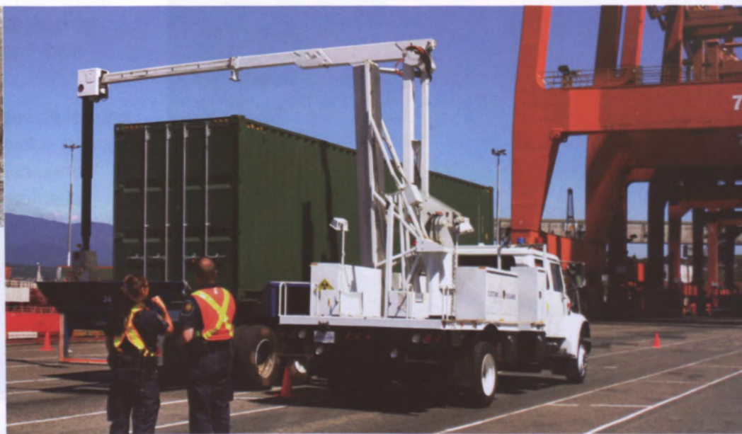
Les groupes terroristes pourraient utiliser des conteneurs pour acheminer les ADM jusqu'à leur cible. L'Agence des services frontaliers du Canada utilise des appareils mobiles d'inspection des véhicules et du fret pour trouver les armes et les marchandises dangereuses cachées dans des conteneurs maritimes.
