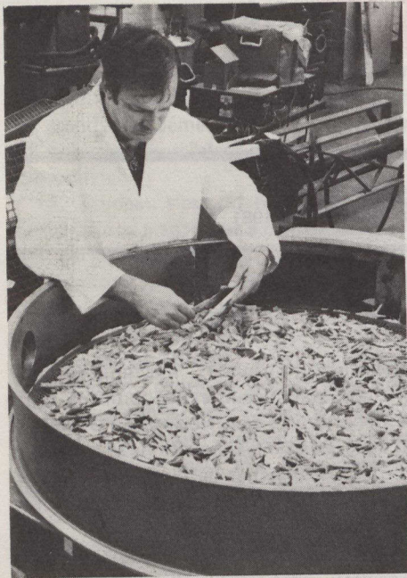
Un chercheur examine des résidus de copeaux de bois tels qu'on les trouve dans la plupart des scieries. Ces résidus pourraient être utilisés pour la fabrication de gaz à partir de la biomasse afin de produire du combustible comme le méthane.
