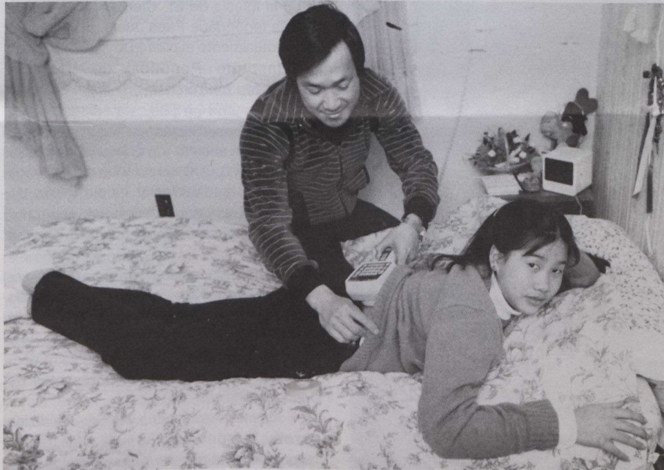
Eddie Chin utiliza un programador manual portátil para ajustar el voltaje del generador de impulsos implantado en la espalda de su hija, Juliana, de 13 años de edad, para corregir el encorvamiento de la columna vertebral.
