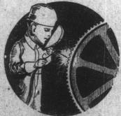
THE ELECTRICAL WELDING OF GEARS
