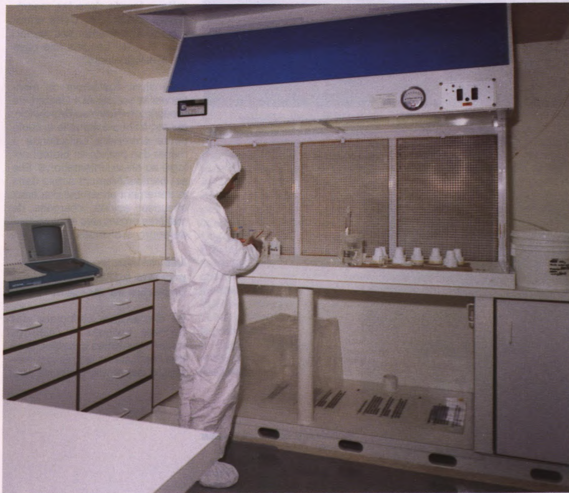
Pièce aseptisée « Class 100 » servant à déterminer le degré de résidus de contaminants environnementaux (CBR International Biotechnologies Corporation)
