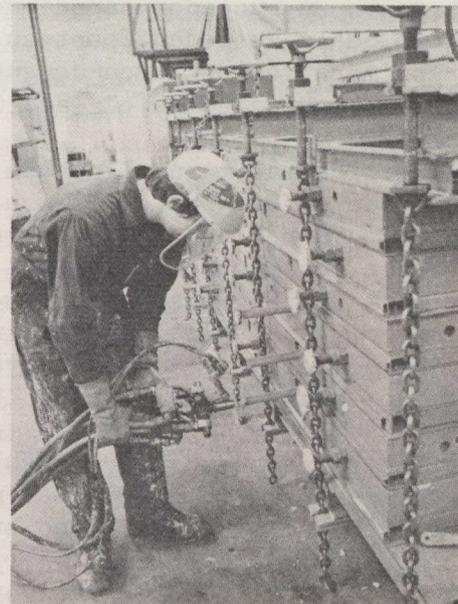
*Daniel Leclerc de la Foster Refrigerator inyecta espuma de uretano entre dos paneles. Esta espuma es el agente utilizado en todas las unidades de refrigeración de la Foster.*
