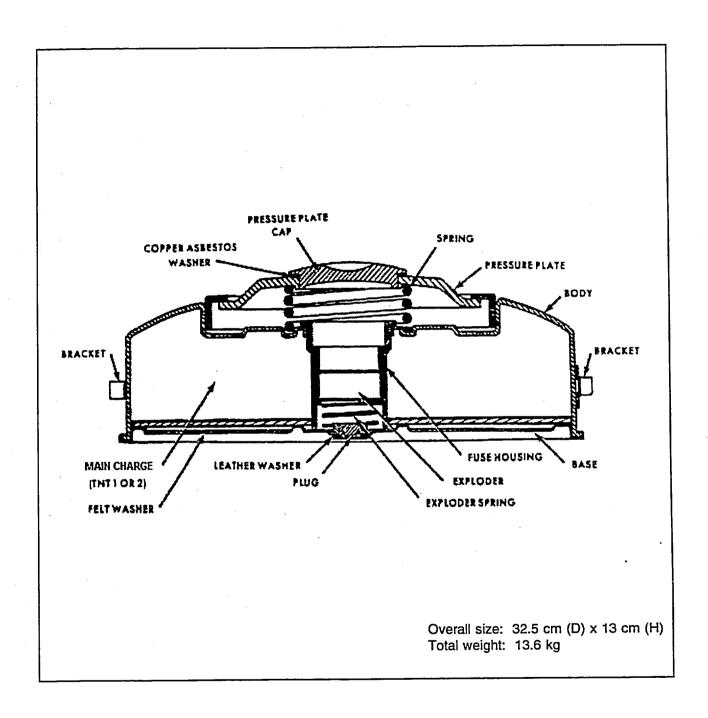
FIGURE 13 - ANTI-TANK MINE MARK 7
