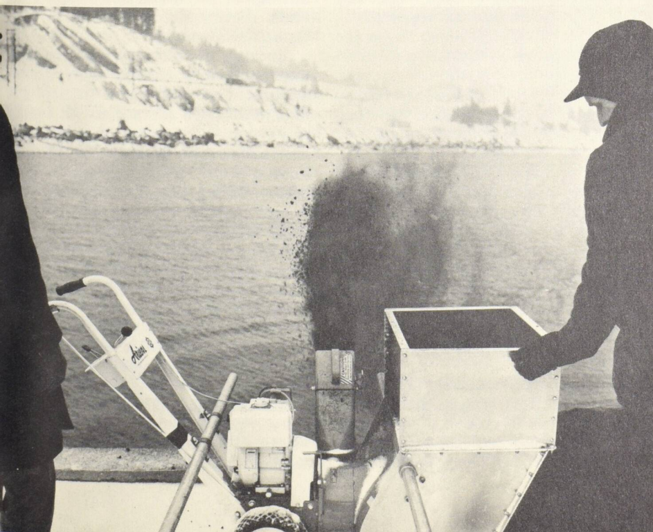
On répand de la tourbe sur le pétrole dans la baie de Chedabucto, au moyen d'une souffleuse munie d'une trémie.
