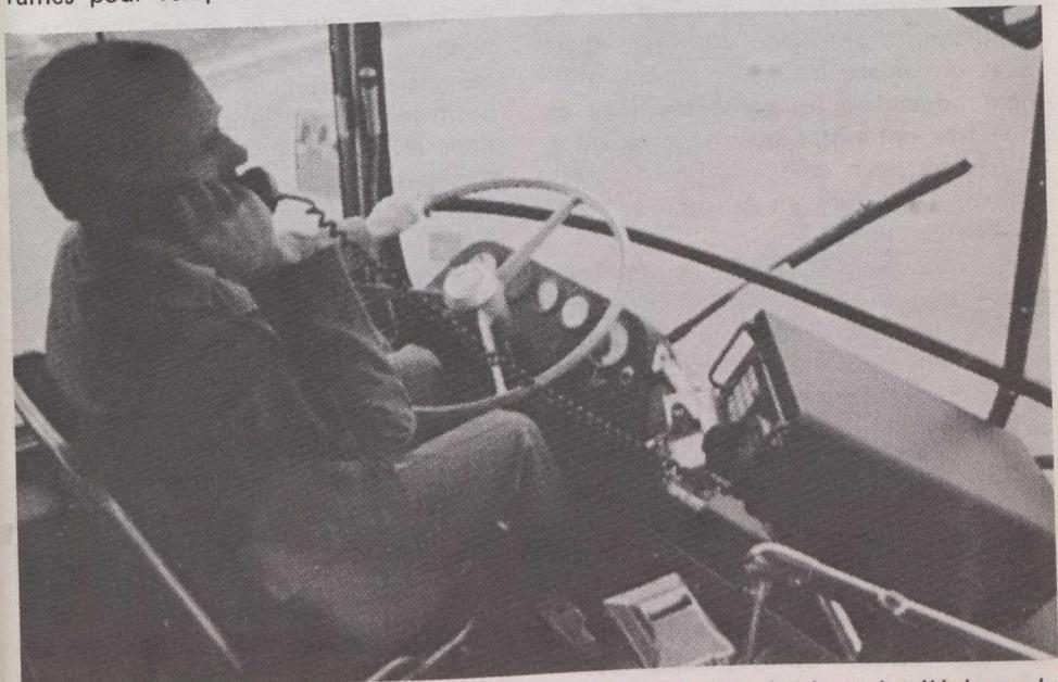
Un autobus équipé d'un système d'information et de communications; le téléphone du chauffeur est relié à une centrale de vérification.
