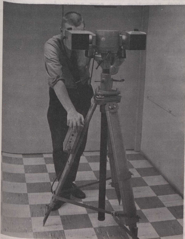
Un opérateur se sert de l'ensemble stéréométrique utilisé dans la nouvelle technique développée à Chalk River pour éviter le séjour prolongé du personnel d'entretien dans les champs de radiation.
