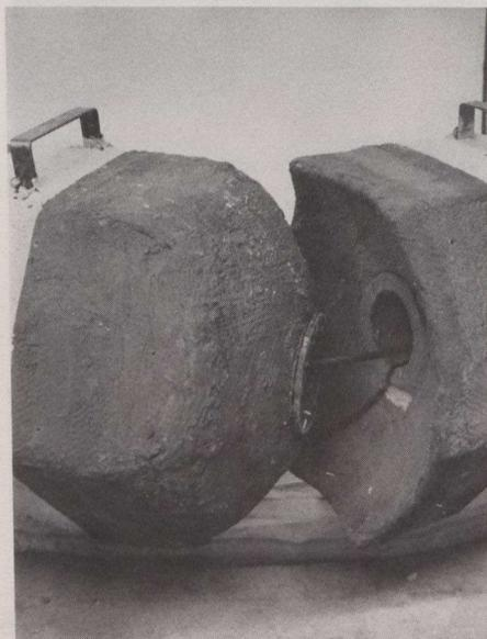
*Ce barrage de caissons à l'épreuve du feu est destiné à retenir le pétrole. Les caissons s'emboîtent les uns dans les autres et conservent leur étanchéité et leur flexibilité.*
