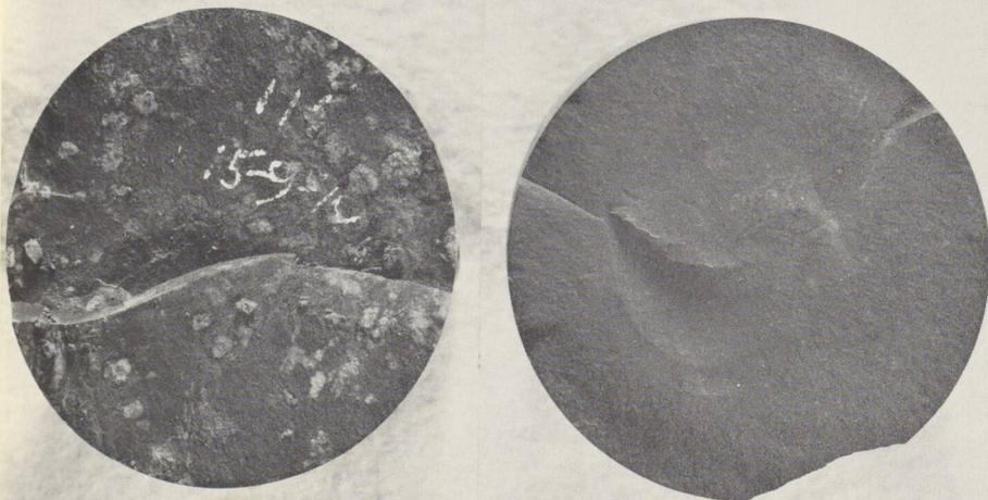
*Des tests en laboratoire permettent de mettre en évidence les différences entre un échantillon de schiste altéré provenant de la partie ouest de l'édifice Bell, après un mois d'activité bactérienne (à gauche) et un échantillon de schiste sain (à droite).*
