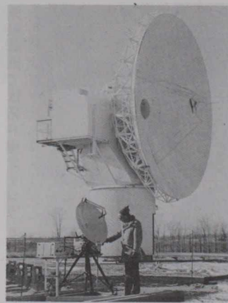
衛星から直接受信するのに使われる直径81センチのパラボラアンテナ（手前）
