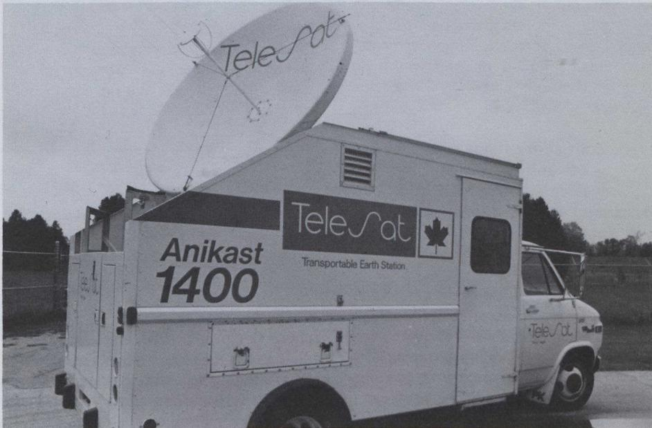
*El servicio de transmisión montado en una camioneta puede hacer que un equipo de transmisión remota inicie su trabajo en 20 minutos.*
