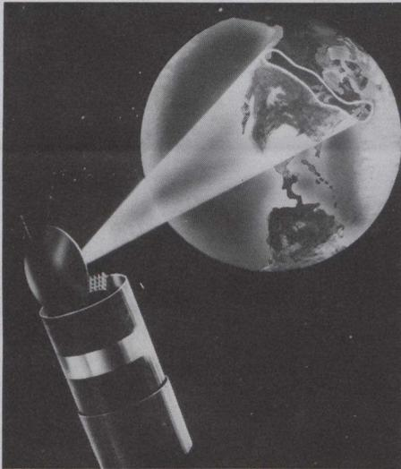
*Dibujo que representa al Anik D2 en el espacio, con el reflector de comunicaciones en posición de transmisión.*
