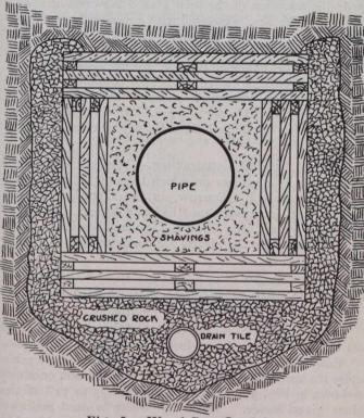
Fig. 5.-Wood Box Conduit.
