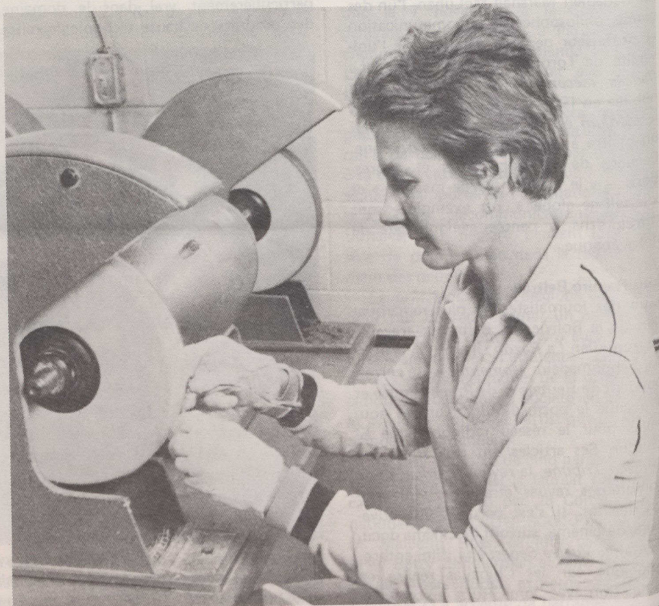
Devant la polisseuse, l'employée utilise des gants blancs pour manipuler chaque monture qui, plus tard, sera polie à la main pour obtenir une surface éclatante.
