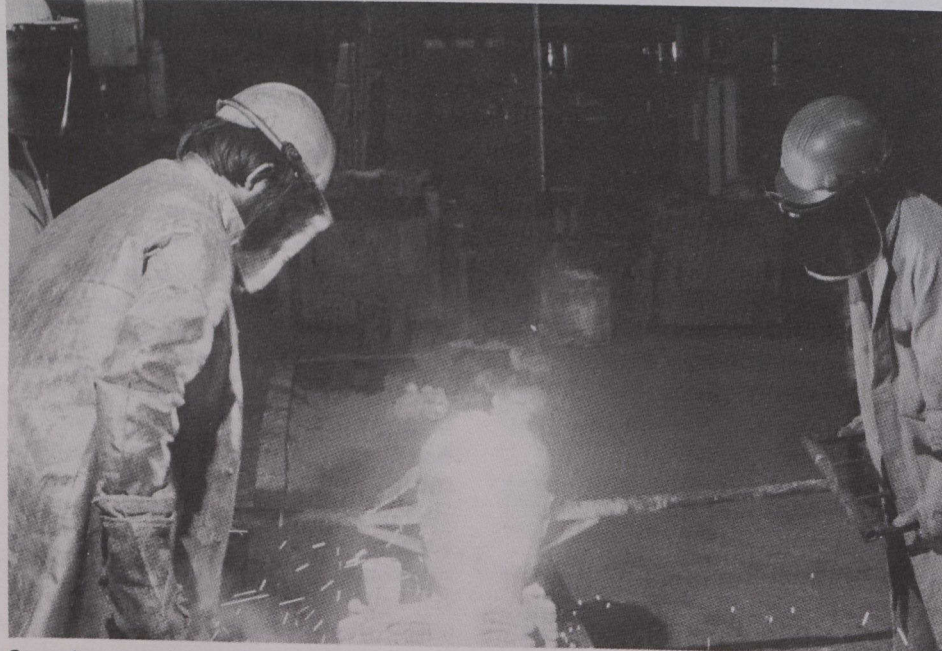
Sous la supervision de leur chef d'équipe, des employés versent du métal en fusion dans un moule de céramique.
