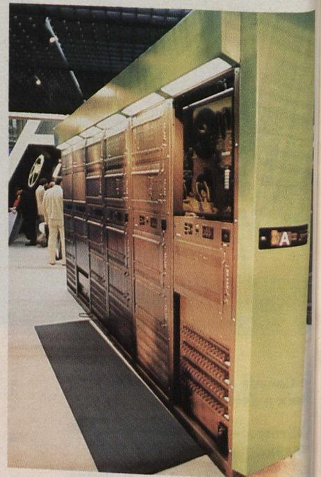
Autocommutateur numérique local DMS 100 de Northern Telecom. D'une capacité de 100 000 lignes, il peut s'intégrer aux réseaux de téléphonie privée, aux terminaux téléphoniques et téléinformatiques, au réseau militaire Autovon, au système de positions de maintenance et d'administration (MAP) et au système de positions automatisées de téléphonistes (TOPS).
