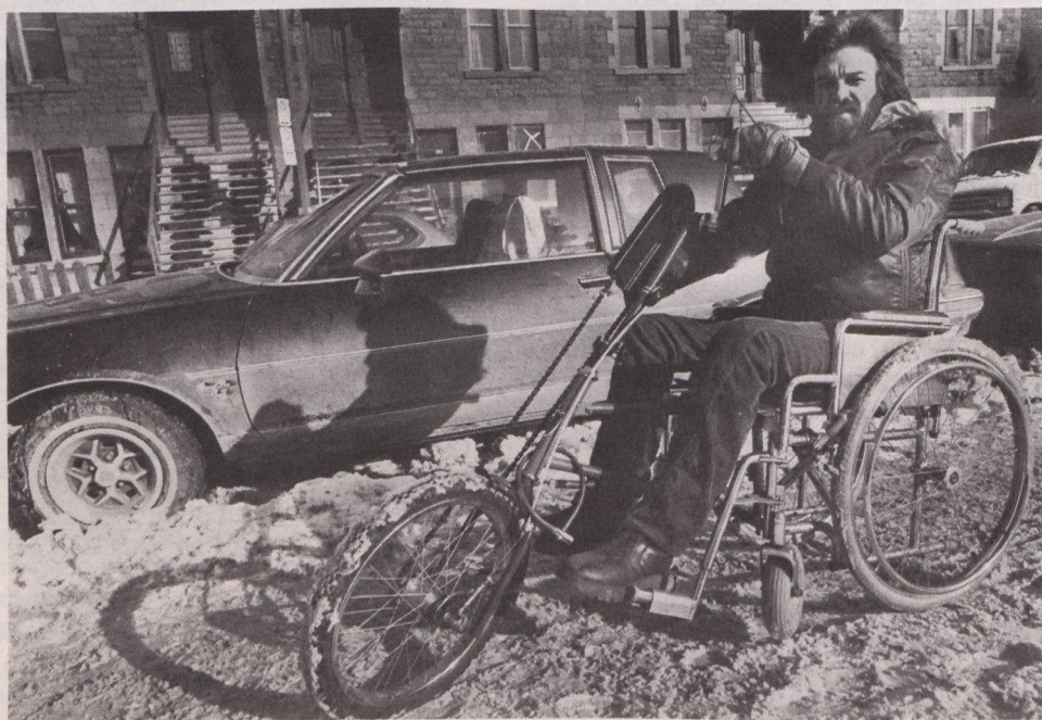
El Unicycle tiene tres velocidades y freno. Se pueden colocar grampas en el neumático para proporcionarle mejor tracción sobre nieve y hielo.
