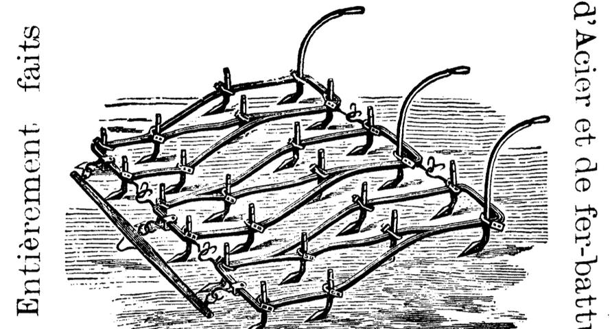
Ces instruments agraires, connus sous le nom de "CULTIVATEURS," sont fabriqués en différentes sections. A chaque section est attachée une poignée, qui en facilite le fonctionnement dans les terrains difficiles. Cette nouvelle invention mérite l'attention de tout cultivateur qui désire retirer un profit de sa terre, et le coût de cet achat sera très certainement remboursé, dès la première année.
