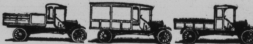
Trois des nombreux genres de carrosserie dont peut être muni le châssis du camion Ford.
