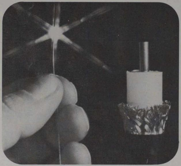
... un cable coaxial tiene capacidad para más de 36 000 canales telefónicos? Su uso, introducido en 1936, se encuentra sumamente extendido por su capacidad de transmisión para sistemas de comunicación, pero recientemente se acaba de lanzar en Canadá la nueva tecnología de "fibra óptica", como la que se muestra arriba junto al cable coaxial. Mide seis milésimos de pulgada de diámetro y proporciona más de 500 000 vías telefónicas unidireccionales.
