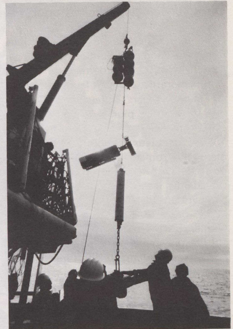
Descente du courantomètre qui détectera la dynamique des systèmes de courants.
