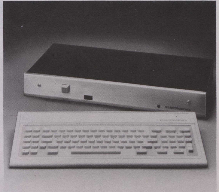
La nueva terminal NALPS para el sistema de Videotexto por televisión. Esta unidad, de bajo costo y fácil utilización, diseñada por la compañía Electrohome Limited de Kitchener, Ontario, es un ejemplo de la avanzada tecnología canadiense en el campo de las computadoras.
