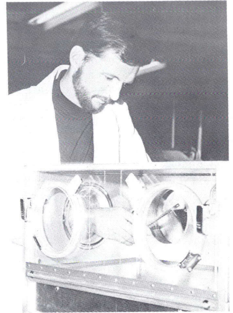
Les parois doubles du nouvel incubateur permettent non seulement une isolation thermique mais également une insonorisation.
