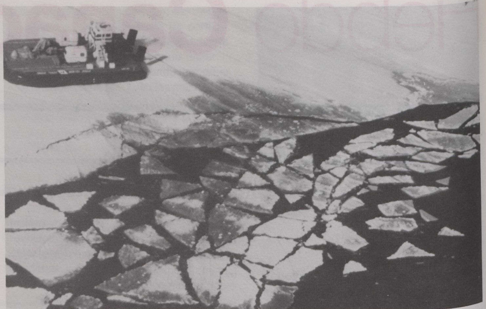
Aérogλισseur détruisant le pied d'un embâcle sur la rivière des Milles-Îles.
