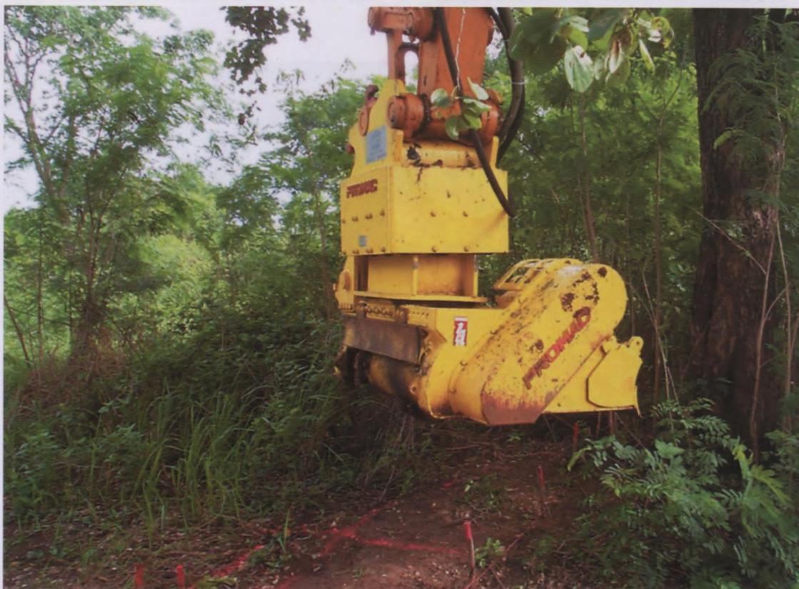
Adaptée aux tâches de déminage grâce à un financement fourni par le programme Partenariat technologique Canada, la débroussailleuse/démineuse BDM 48 de PRO MAC est ici mise à l'essai en Thaïlande.
