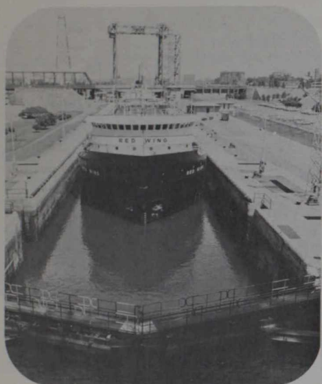
El llenado de la esclusa toma unos cuantos segundos
