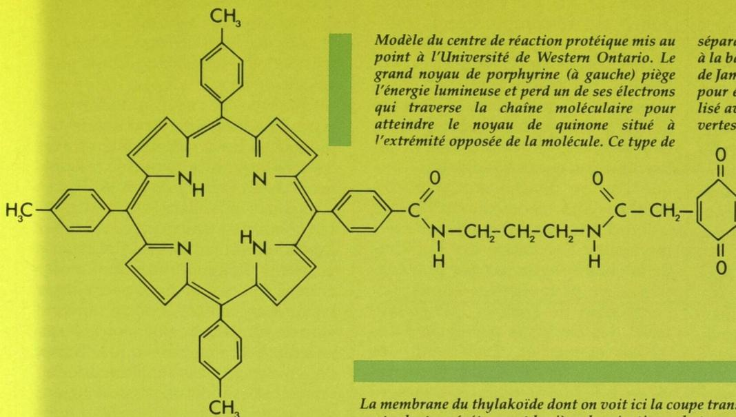
Modèle du centre de réaction protéique mis au point à l'Université de Western Ontario. Le grand noyau de porphyrine (à gauche) piège l'énergie lumineuse et perd un de ses électrons pour atteindre le noyau de quinone situé à l'extrémité opposée de la molécule. Ce type de
