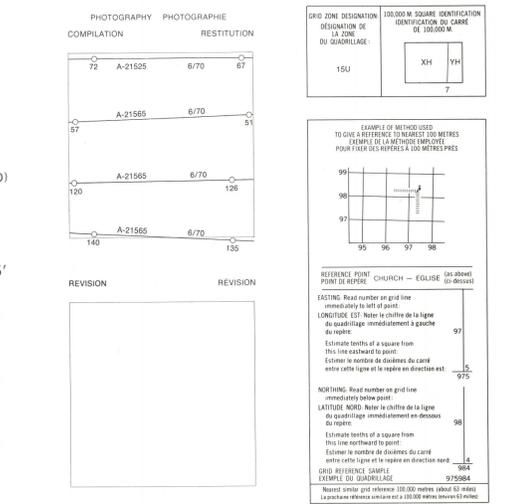
**ONE THOUSAND METRE UNIVERSAL TRANSVERSE MERCATOR GRID ZONE 15 QUADRILLAGE DE MILLE MÈTRES UNIVERSSEL TRANSVERSE DE MERCATOR**
