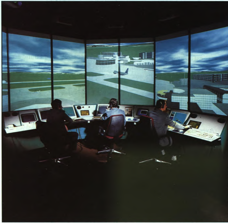
La première tour de simulation à 360° au monde pour le contrôle du trafic aérien. Une réalisation ATS Aérospatiale.
