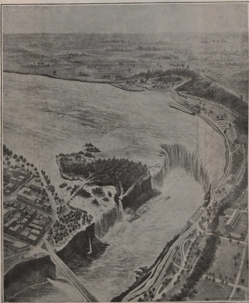
Vue à vol d'oiseau des chutes Niagara et des alentours, montrant les trois grandes usines hydrauliques construites sur le côté canadien, pour la production d'une force motrice égale à 415,000 chevaux-vapeur.
