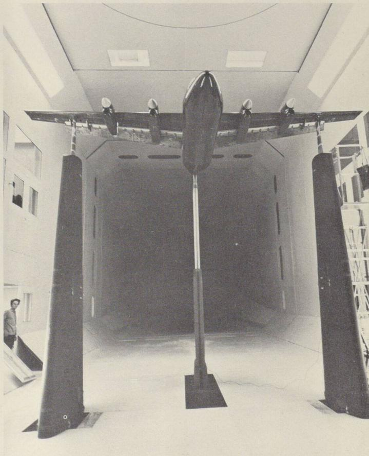
De Havilland's DHC-7 model under test in a wind tunnel at the National Aeronautical Establishment. • Maquette de l'avion De Havilland DHC-7 aux essais dans une soufflerie de l'ÉAN.
