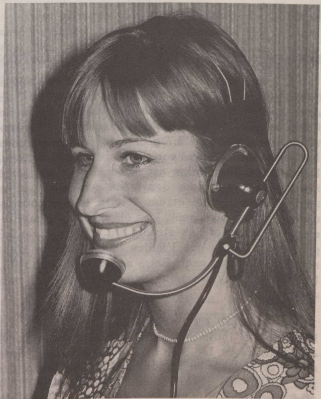
Le casque téléphonique classique pèse environ une demi-livre et nécessite un serre-tête. Le bruit de fond peut causer des ennuis.
