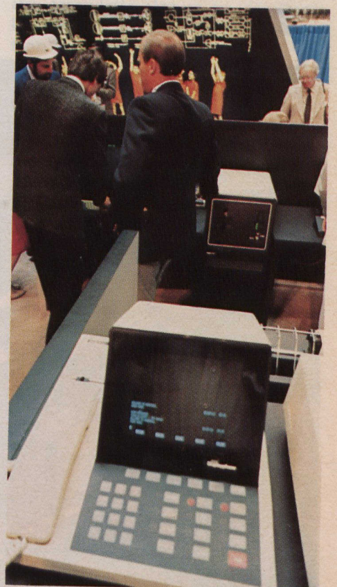
Terminal téléphonique et téléinformatique de bureau de Northern Telecom, le premier du genre au monde (Displayphone).
