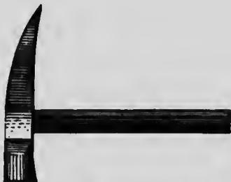
Fig. 40.—Marteau de drainage.
