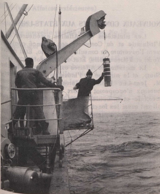
Un instrument mesurant la qualité de l'eau est descendu dans les profondeurs du lac Ontario au cours de recherches hivernales.
